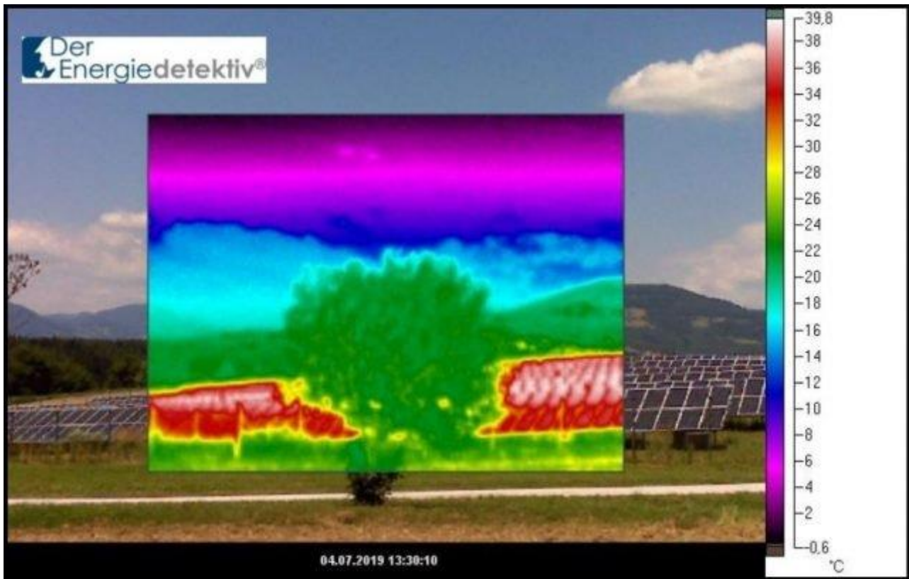
Das Wärmebild zeigt die unterschiedliche Nutzung des Sonnenlichts: Während Baum und Wiese die Sonnenenergie in Biomasse umwandeln, wandeln Solaranlagen einen Großteil in Wärme um und geben sie an die Umgebung ab. Foto: Mit freundlicher Genehmigung / Der Energiedetektiv
